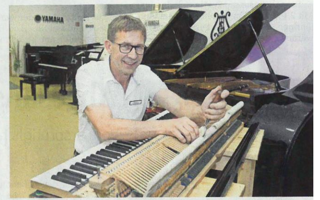
Klavier-Baumeister Bert Kirsten erneuert Filzbeläge an einem Flügel – und sinniert derweil über Innovationen für ein konservatives Handwerk.
